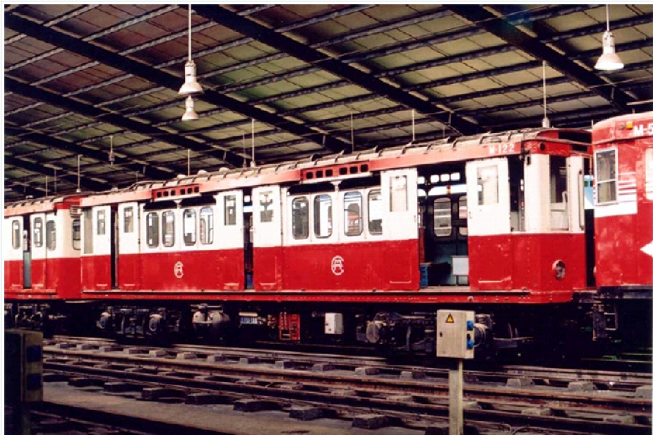
Imagen 4: Coche M-122, del tipo "Quevedo". Bogies Brill 77-E-2.
