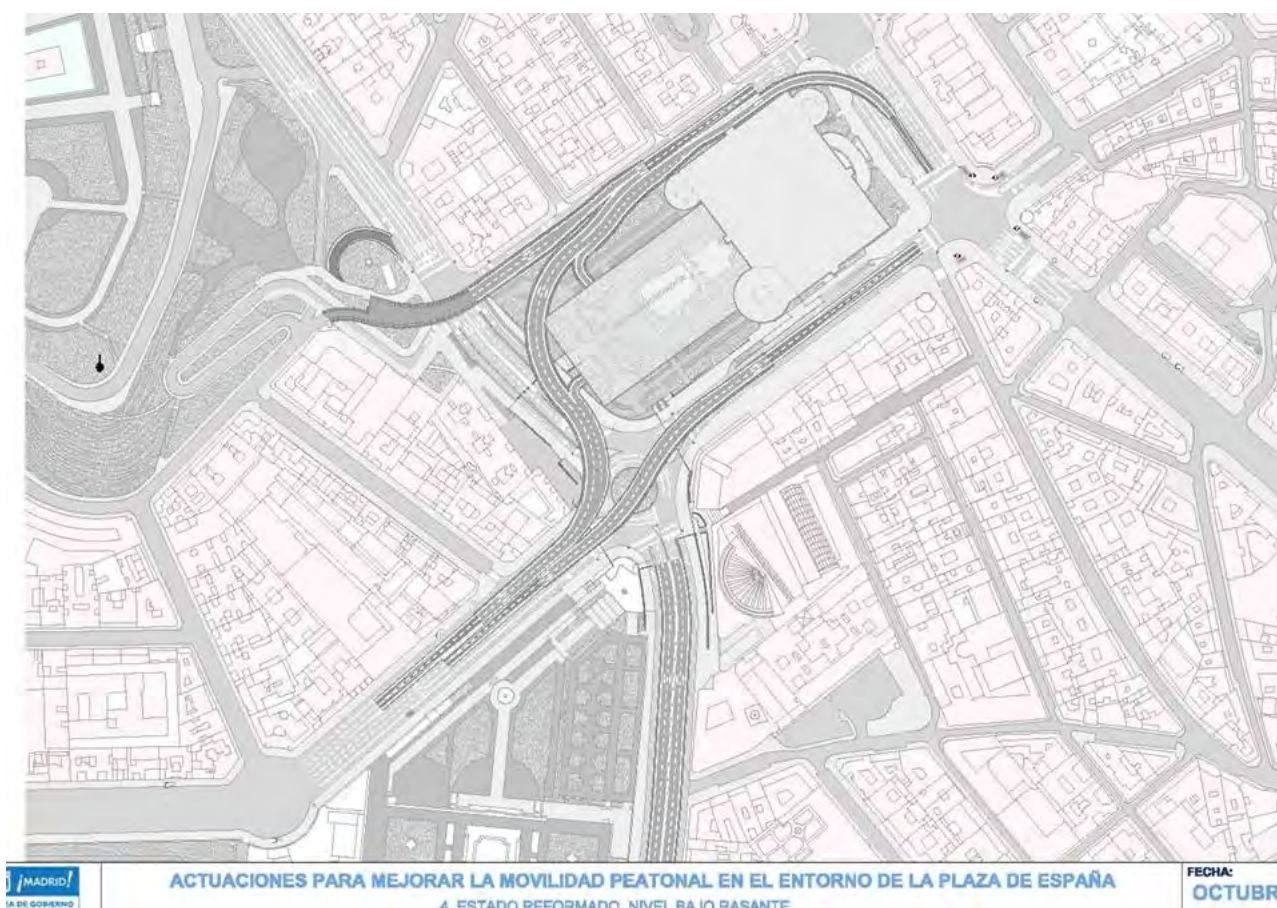
Fig. 237– El esquema muestra los nuevos túneles previstos para dar acceso al nuevo aparcamiento subterráneo tras su ampliación, y su enlace con las vías circundantes.
