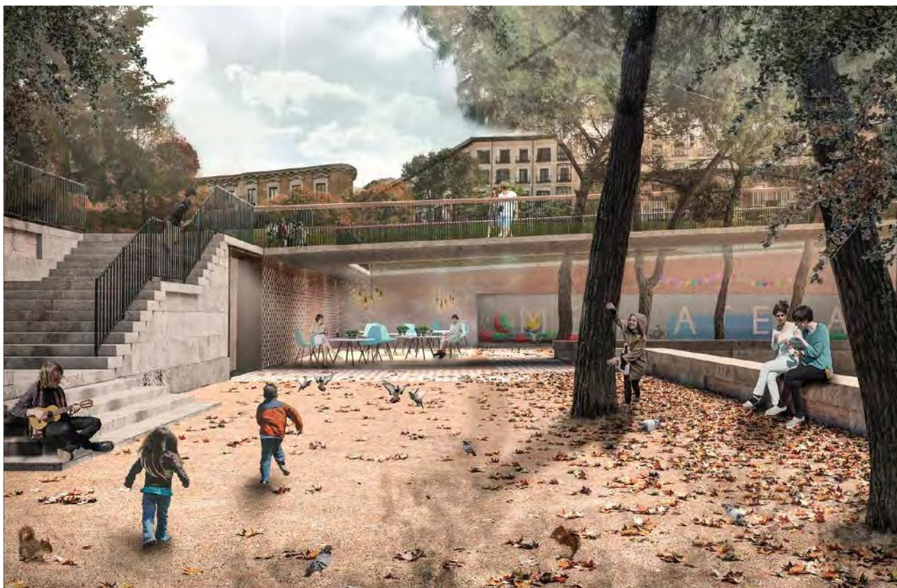
Fig. 84- Vista de la rampa volada mirando hacia el Este. Se observa perfectamente su función de voladizo protector para las sillas y mesas del nuevo restaurante. Arquitectos: Estudio Guadiana y Porras La Casta.
